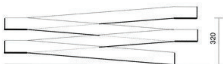
Dislivello massimo consentito mediante il superamento con sole rampe inclinate
